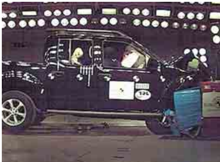
Nissan Navara. Οι Ιάπωνες έσπευσαν να το ενισχύσουν σε ζωτικά σημεία του αμαξώματος, επειδή στις πρώτες δοκιμές πρόσκρουσης κόντεψε να διαλυθεί
